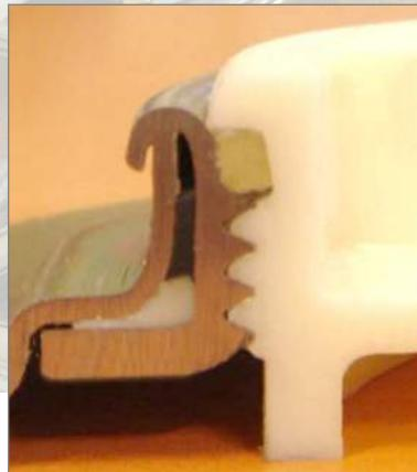
mit dem empfohlenen Anzugsmoment festgezogen wird. Der Haltering stellt sicher, dass die Dichtung beim Aufdrehen des Stopfens in Position bleibt, und reduziert so die Gefahr, dass die Dichtung „kleben bleibt“
