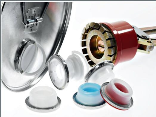
Der UNI-GRIP® 60C ist ein Kunststoffverschluss mit integriertem Ausgießer für kleine und mittelgroße Metall- und Kunststoffbehälter. Dieser äußerst praktische Verschluss verbindet einen Kunststoffdeckel mit einem hochziehbaren Ausgießer (Balg, Ausziehtülle) sowie einem Sicherungsmechanismus, der das Füllgut vor Manipulation schützt und seine Unversehrtheit gewährleistet.
