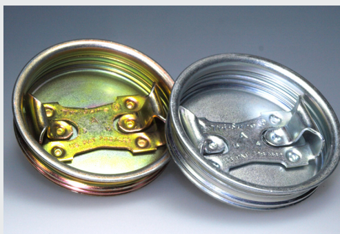
Linker Verschluss: Goldfarbene Chrom VI-Passivierung Rechter Verschluss: Platinfarbene Chrom III-Passivierung
