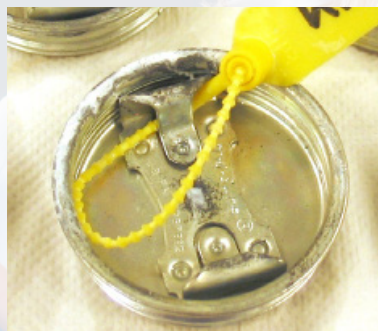
Chrom III-Passivierung: Ergebnis nach 240 Stunden Neutralsalz-Sprühtest
