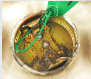
Chrom VI-Passivierung: Ergebnis nach 240 Stunden Neutralsalz-Sprühtest
