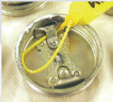
Pasivación cromo 3: Resultado de 240 horas en teste neutral salt spray.
