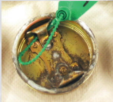
Pasivación cromo 6: Resultado de 240 horas en teste neutral salt spray.
