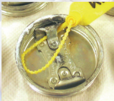
Passivação cromo 3: Resultado de 240 horas em teste neutral salt spray
