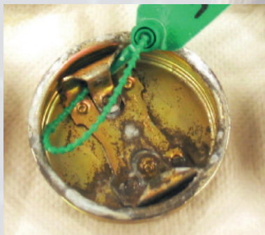
Passivação cromo 6: Resultado de 240 horas em teste neutral salt spray
