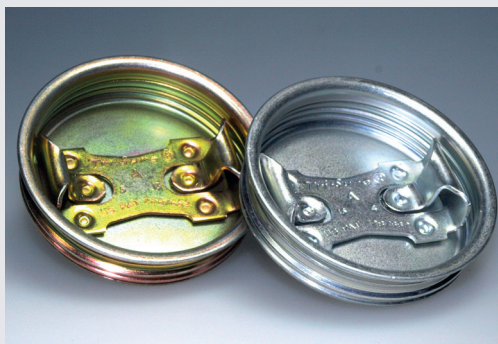
Bujão da esquerda: Passivação cromo 6 dourada Bujão da direita: Passivação cromo 3 prateada
